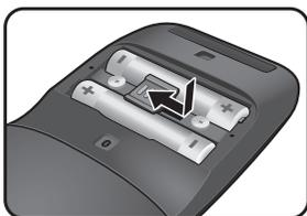
d) 電池収納部のラッチをロックします。
